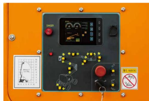
Steuerung unten am Auslegerbaum und oben an der Bühne kommunizieren mit Kommutierungsschaltern, wobei die Bühne vorrangig ist und die untere Steuerung sperren kann. Beide Systeme sind geschirmt.
