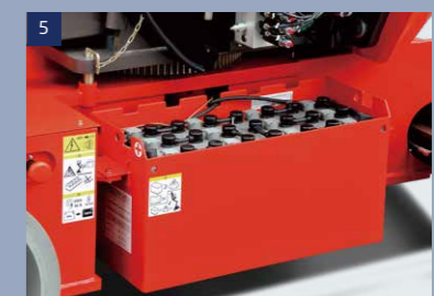
Standardantriebsbatterie mit um 40% verringerter Ladedauer, Lebenszeit um 50% erhöht
