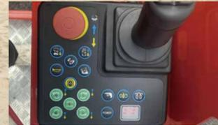
Tragbare Steuerbox mit Fahr- und Hubfunktion und ein Taster für die automatische Nivellierung. Die Lenkung ist am Ende des Joysticks angeordnet, so dass mit einer Hand die Fahrgeschwindigkeit, die Lenkfunktion und die Hubhöhe der Plattform flexibel gesteuert werden kann.
