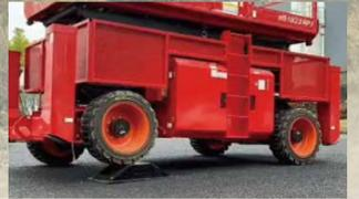
Die Pendelachse sorgt für einen ständigen Kontakt der Reifen mit dem Boden, sorgenfreies Arbeiten bei unebenem Untergrund.
