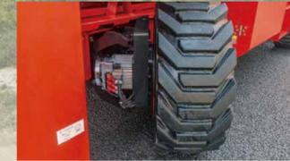
Permanentmagnet-Synchronmotor, Energieeffizient, Leistungsstärker, IP67 Schutzklasse.
