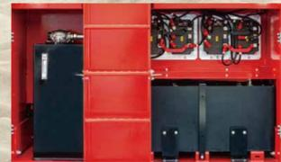
Leistungsstarke Lithium-Eisenphosphat-Batterie, serienmäßig sind zwei Lithium-Eisenphosphat-Batteriepacks kombiniert für eine Gesamtkapazität von 19kWh. Die Plattform ist mit einer Notstromversorgung für die sichere Notabsenkung ausgestattet. Im Falle eines Ausfalls oder anderer plötzlich auftretenden Störung, kann der Bediener auf den Notbetrieb umschalten, um die Plattform sicher abzusenken.
