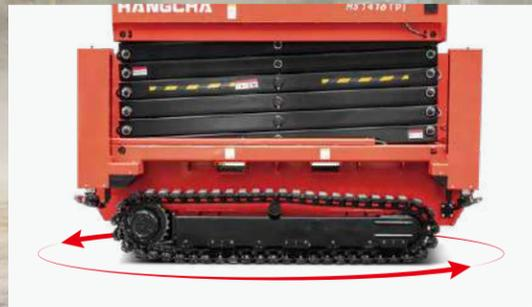
Mit Proportionalverzögerung in der Lenkung und elektronischem Differenzial kann am Platz gewendet werden.
