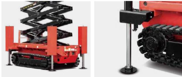
Schnell und präzise ist der ebene Zustand eingestellt. Die automatische Nivellierung kann durch Knopfdruck blitzschnell durchgeführt werden. Auch einzeln lassen sich für Sonderanwendungen die Auslegerfüße bedienen.
