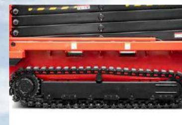
Mit Schutzklasse IP 67 ist der Motor staubdicht und kann zeitweise sogar in Wasser eintauchen. Kraftvoll im Gelände durch Raupenantrieb mit Untersetzungsgetriebe.
