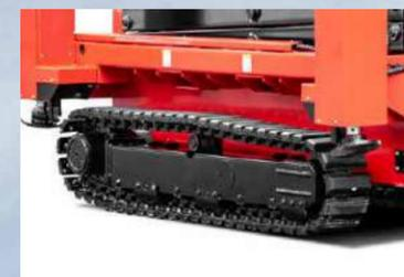
Mit dem griffigen Raupenfahrwerk bleibt fast kein Ort unzugänglich. Der vollversiegelte Motor mit Permanentmagnet und Synchronantrieb bietet höchste Leistung und Effizienz.
